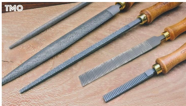
11. ตะไบ ใช้ในการตะไบแต่งรูทรงใบมีดและยังใช้ในการขัดคมมีดให้มีความบางและเรียบเนียนเสมอกัน ตะไบที่ช่างมีดใช้จะมี 3 ประเภท คือ
